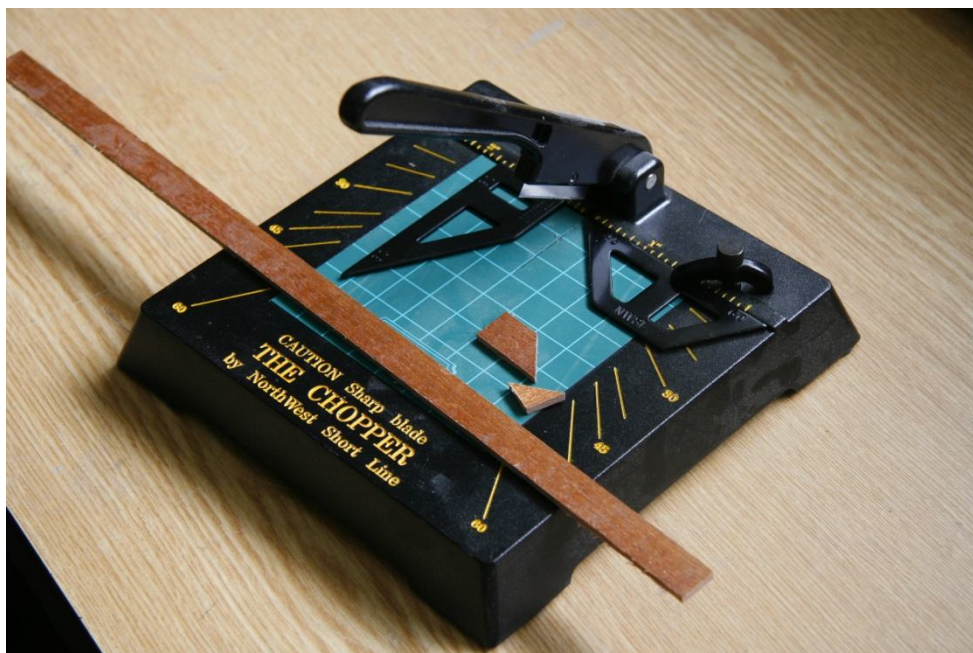
Figuur 10 The Chopper; vooral handig voor kunststof en hout. Dun messing en aluminium kan ook...
